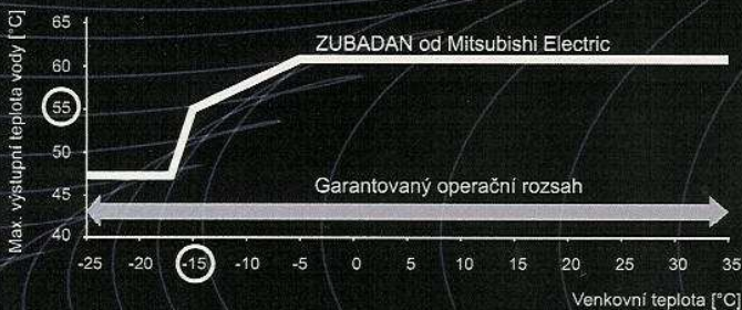
Závislost výstupní teploty vody na venkovní teplotě
